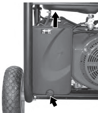
Демонтаж на капака на въздушния филтър
